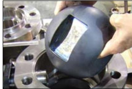
Rivestire la sfera con un sottile strato di grasso siliconico.
