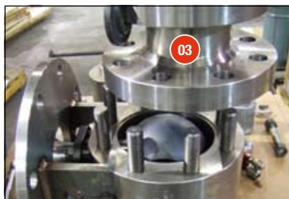
Posizionare i raccordi terminali su una superficie liscia in posizione verticale con la flangia verso basso.
