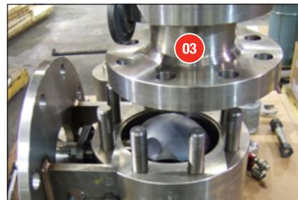
Placer la connexion d'extrémité sur une surface plane en position verticale avec l'extrémité bombée vers le bas.
