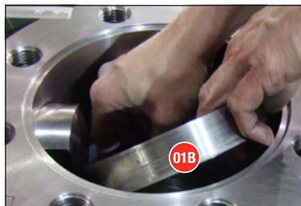
*L'identification de bague de siège est également indiquée à l'intérieur de la rainure de tige de la bille pour assurer un assemblage correct.*
