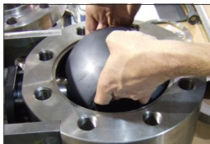
La bille **01A** doit « basculer » lorsqu'elle est correctement positionnée.
